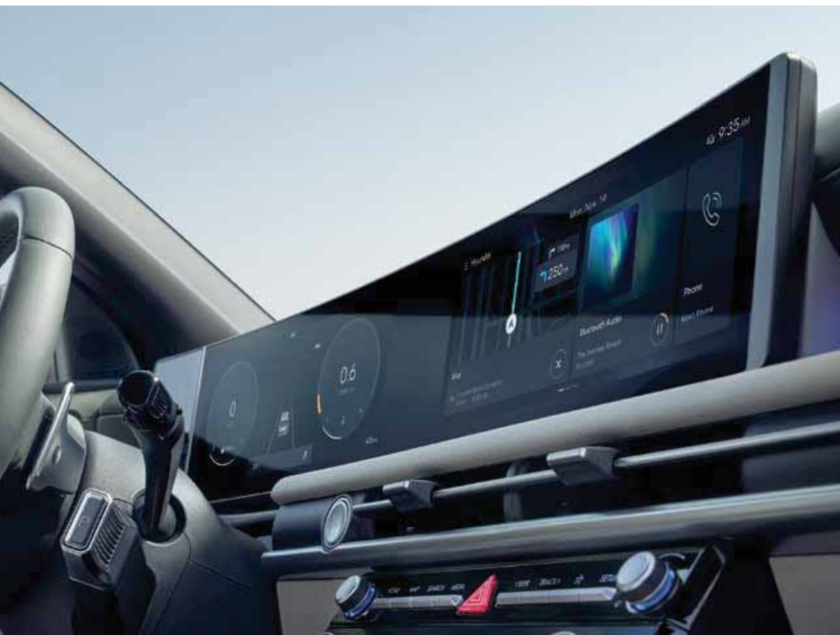
L'écran panoramique aux courbes élégantes comprend deux écrans intégrés pour un look high-tech : un écran tactile d'infodivertissement de 12,3" et un combiné numérique de 12,3".
