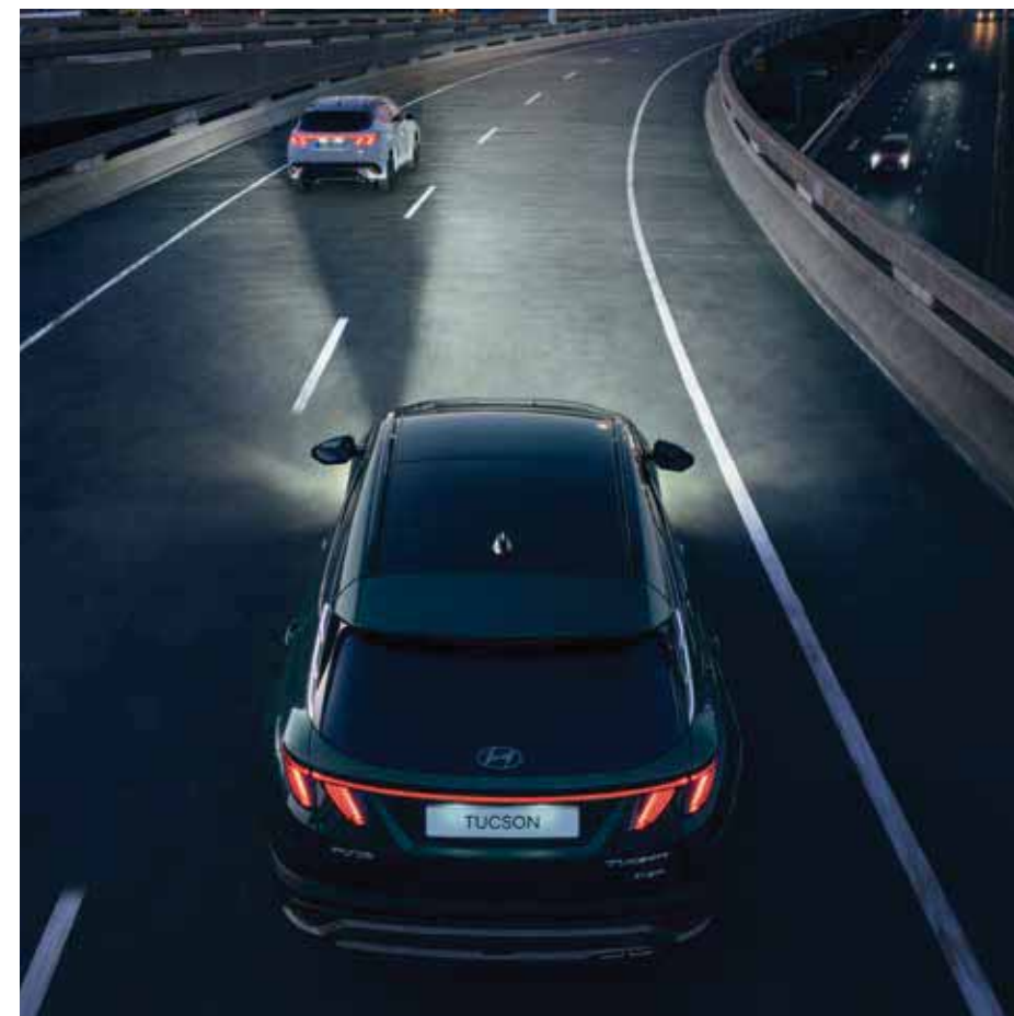
L'Intelligent Front-Lighting System (IFS) offre les meilleurs niveaux d'éclairage, s'adapte automatiquement aux conditions de circulation et maximise l'utilisation des feux de route sans éblouir les véhicules circulant en sens inverse.
